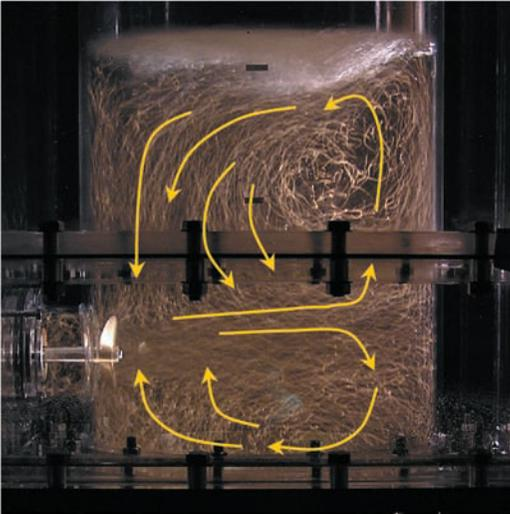
螺旋桨叶片(侧面安装)的流动型态分析
